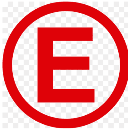
Rysunek 8. Oznaczenie zewnętrznego włącznika systemu gaśniczego / Diagram 8. Indication of the external switch for the fire extinguishing system.
